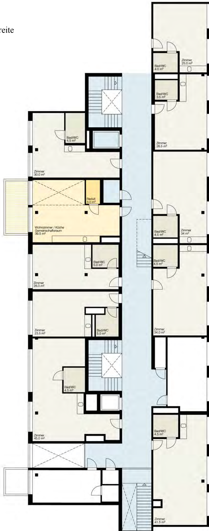
Abb. 14: Grundriss der Clusterwohnung im 4. Obergeschoss Mst. 1:200
