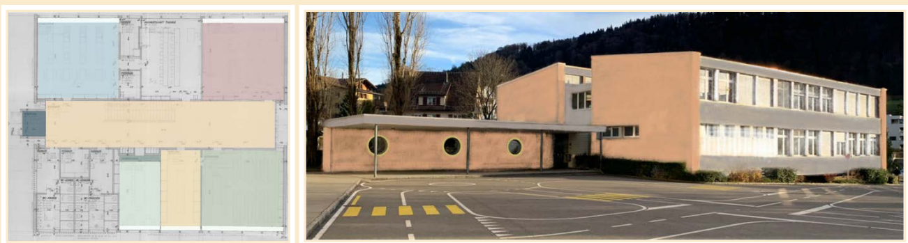
Abb.12 und 13: Skizzen der sondierten Wandfarben im Erdgeschoss und den Fassaden aus dem Untersuchungsbericht 2023.
